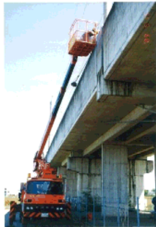
衝撃振動試験実施風景
